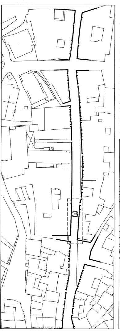
Lungo un tratto di strada urbana in lieve pendenza, attualmente in asfalto, si sono verificati avvallamenti dovuti alla cattiva regimentazione delle acque meteoriche, al sottodimensionamento della rete di smaltimento e allo stazionamento di un bus urbano, in corrispondenza dell'incrocio.
